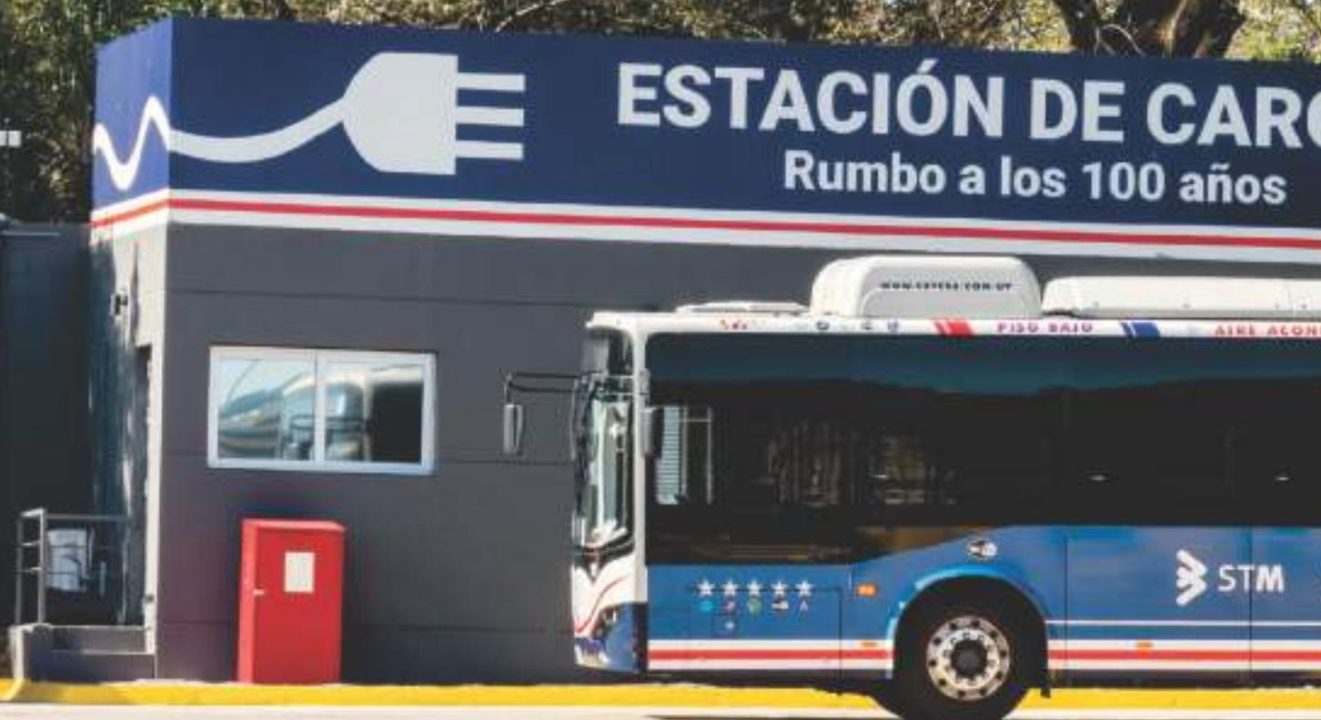
El proyecto Centro de Carga en Planta Añón está planificado para abastecer la carga simultánea de 100 buses. En la primera etapa tiene operativos 23 cargadores BYD, cada uno con potencia de carga 80kW (40kW x 2).
